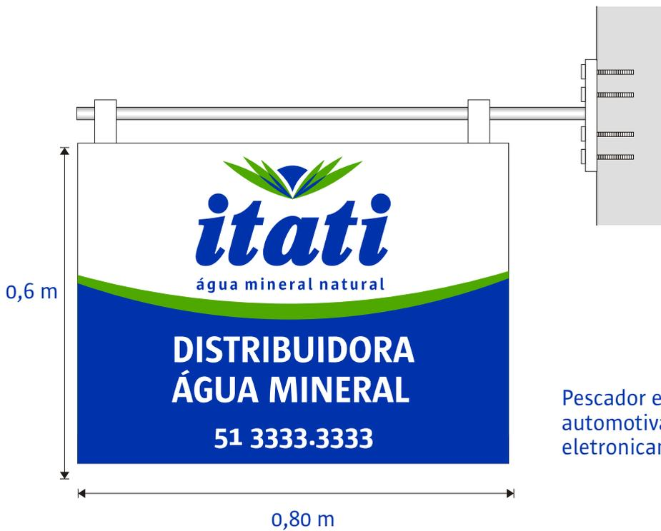
Pescador em aço galvanizado, com pintura automotiva e adesivo vinil recortado eletronicamente.
