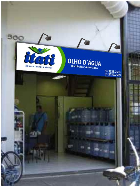
Testeira em aço galvanizado, com pintura automotiva e adesivo vinil recortado eletronicamente. Uso de letra-caixa na logomarca. Iluminação frontlight.
